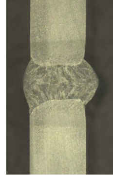
Malzeme kalınlığı 5 mm Boşluk 3 mm
