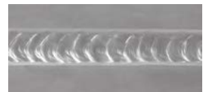
Alüminyumda pulse on pulse (Şekil 2)
