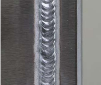
AlMg5, malzeme kalınlığı 4 mm
