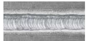
Alüminyumda Pulse kaynak (Şekil 1)
