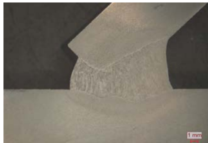
10 mm malzeme kalınlığında gövde levhası, 35° kaynak ağızı açısı
