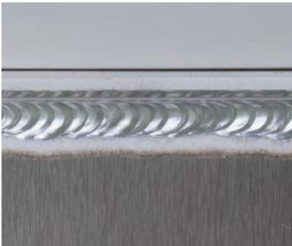
AlMg5, malzeme kalınlığı 4 mm
