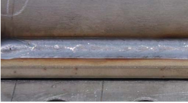
Ön taraf: forceArc puls ® düşük ısı girdisi, yüzeyde daha az oksidasyon, bu şekilde daha iyi bir görünüm
