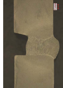
Malzeme kalınlığı 10 mm, tek taraflı kaynak ağızı açısı 15 derece, 4 mm boşluk
