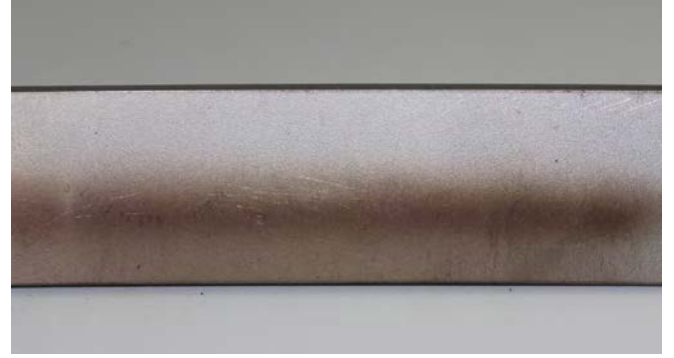
Arka taraf: forceArc puls ® düşük ısı girdisi, yüzeyde daha az oksidasyon
