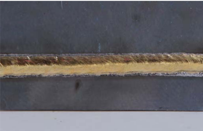
Usibor ® gibi yüksek dayanımlı malzemelerin lehimlenmesi
