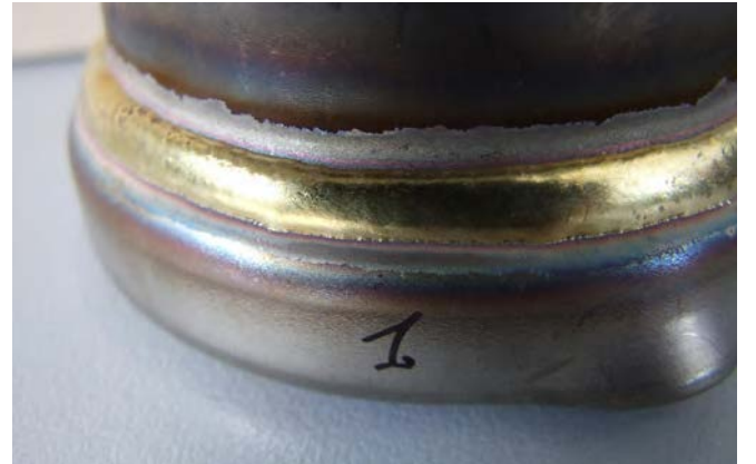
Yüksek alaşımlı (CrNi) çeliklerin lehimlenmesi
